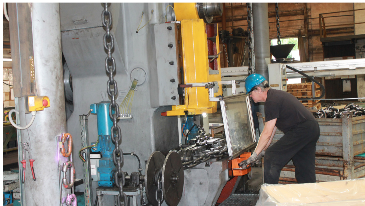
Automatické značení řetězů od průměru 18 mm.
